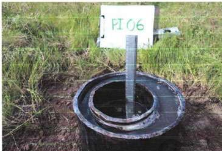
Figura 211. Prueba de infiltración por el método de los anillos en El Judío, Ejido Tlapacoya, Pachuca, Hidalgo.
